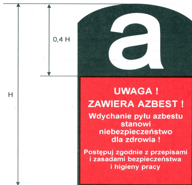
Rys.4.1. Wzór etykiety do oznakowania wyrobów i odpadów zawierających azbest, zgodnie z załącznikiem do Rozporządzenia Ministra Gospodarki, Pracy i Polityki Społecznej z dnia 2 kwietnia 2004 r. w sprawie sposobów i warunków bezpiecznego użytkowania i usuwania wyrobów zawierających azbest.
